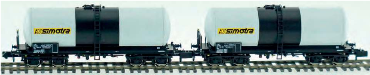
NW-228 • Set de 2 citernes citernes "SIMOTRA" Bogies Y 25S, n°21 87 007 8406-7 et n°33 87 007 8412-5 Transport de Produits pétroliers - Époque IV
